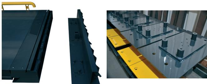
Le pont-bascule ProDeck M est livré avec des plaques de réception inférieures à spitter au sol, évitant les réservations dans les massifs béton ainsi que les scellements après montage (version pour sol compacté disponible). Dans le cas d'une implantation hors sol, les plaques d'extrémités intègrent des têtes métalliques simplifiant l'implantation des rampes.
